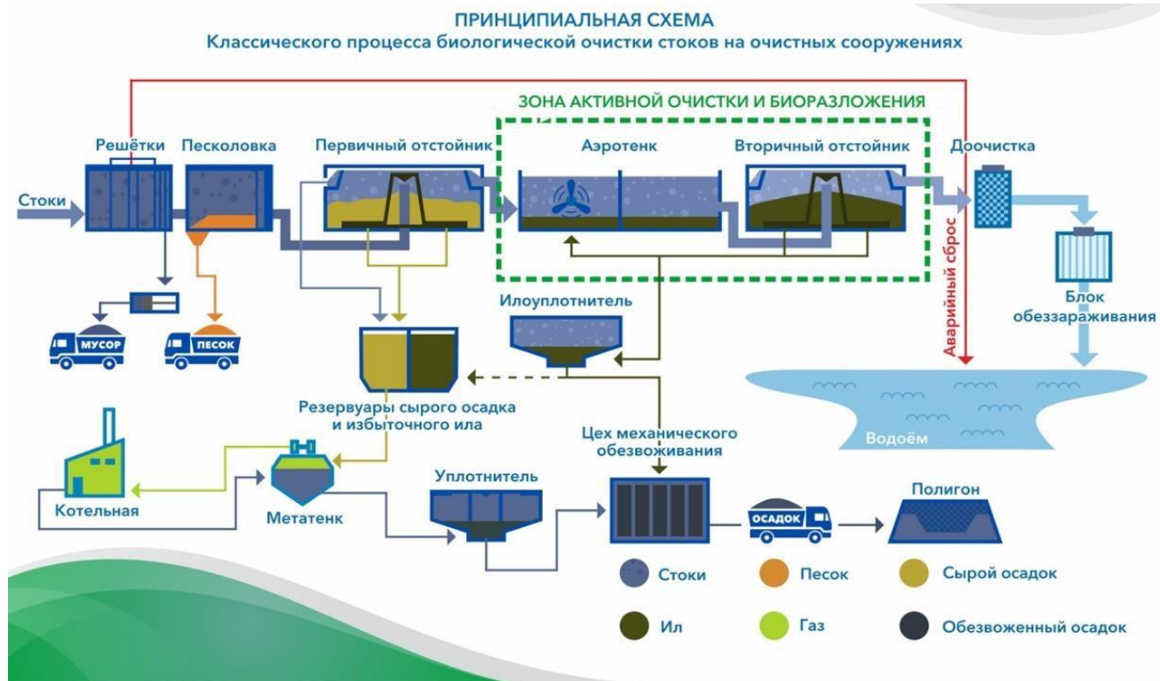
3 - сурет – Тазарту қондырғыларындағы ағынды сулардың биологиялық тазартудың классикалық үдерісінің принципіалды сызбасы
